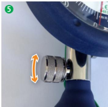
1. Per l'utilizzo, chiudere la valvola di sfogo ruotando la vite a testa zigrinata (Figura 5) e collegare il manometro, eventualmente tramite un tubo flessibile, con la linea di ventilazione della cannula tracheale o al tubo endotracheale. Al riguardo è necessario controllare che, su tutti i collegamenti provvisti di valvola antiritorno, questa venga azionata dal connettore Luer collegato.
